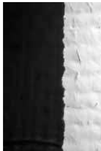
Foto 8: Aparición de pequeñas grietas en el perímetro de las muestras.
