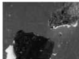
Foto 7: Microfotografía con lupa binocular a 75 X. Se muestra la comparativa entre la micromuestra azul cobalto sometida a envejecimiento por HR y T (abajo) y la sometida a envejecimiento por UV que resulta más clara (arriba).
