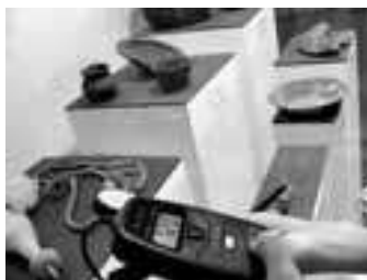
Foto 3: Mediciones de luz visible y UV en las salas de exhibición del Museo para propuestas de conservación preventiva. Línea infraestructura (M. Morales, 2011).
