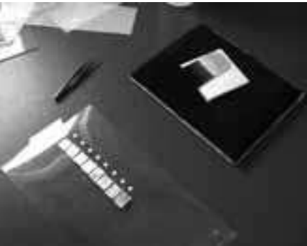
Foto 3: La muestra constituida por una escala de espesores de láminas de oro sobre un soporte de Mylar de 200 µm.
