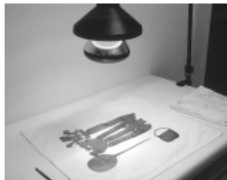
*Foto 3: Eliminación del agua adquirida en el tratamiento, por medio de la aproximación a una lámpara infrarroja.*
