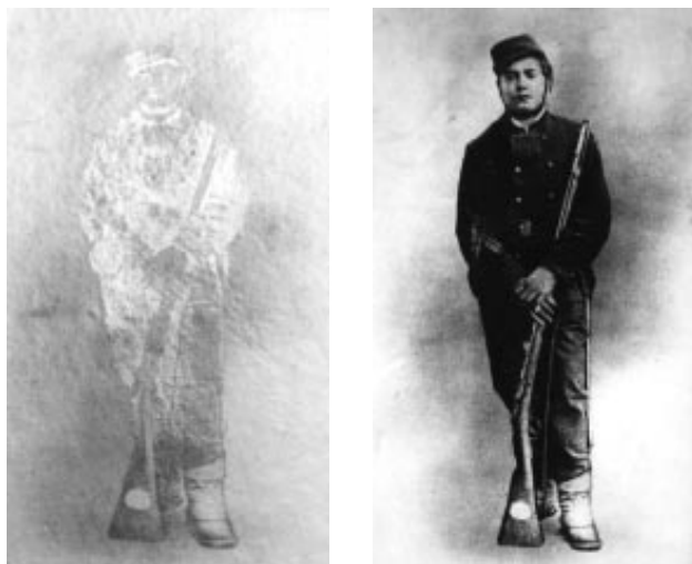
Fotografía con deterioro de brillo metálico "silver mirroring"
