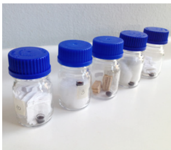
Figura 3. Análisis de ácido cromotrópico para la caracterización de formaldehído (Fotografía: Araya, C. 2015). Chromotropic acid test for formaldehyde characterization (Photograph: Araya, C. 2015).
