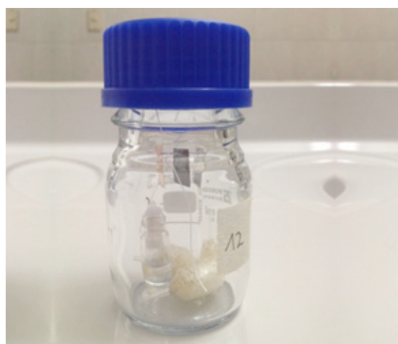
Figura 2. Frasco de análisis, test de Oddy (Fotografía: Araya, C. 2015). Analysis bottle, Oddy test (Photograph: Araya, C. 2015).
