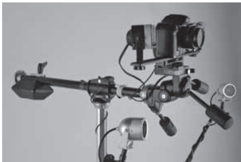
Foto 14: Montaje de los iluminadores y la cámara.
