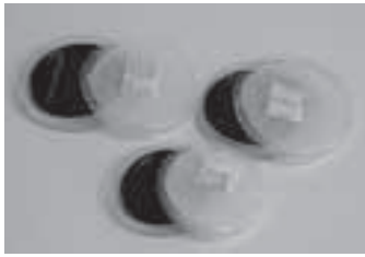
Foto 2: Filtros infrarrojos, opacos al paso de la luz visible.
