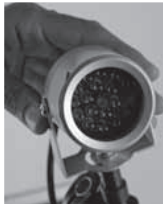
Foto 9: Iluminador infrarrojo 850 nm, 10 m, 80°.
