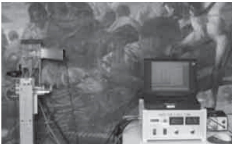
Foto 1. Espectrómetro portátil de Fluorescencia de rayos X: Art-FRX durante las mediciones de la pintura de caballete “Colonización de México”, Francisco Sans y Cabot (1828-1881)
