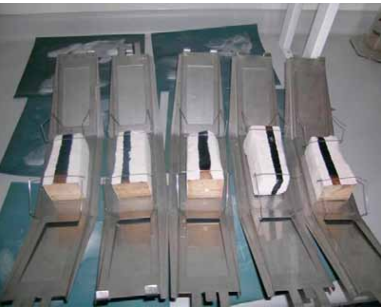
Foto 1: Bloques montados en los portamuestras.
