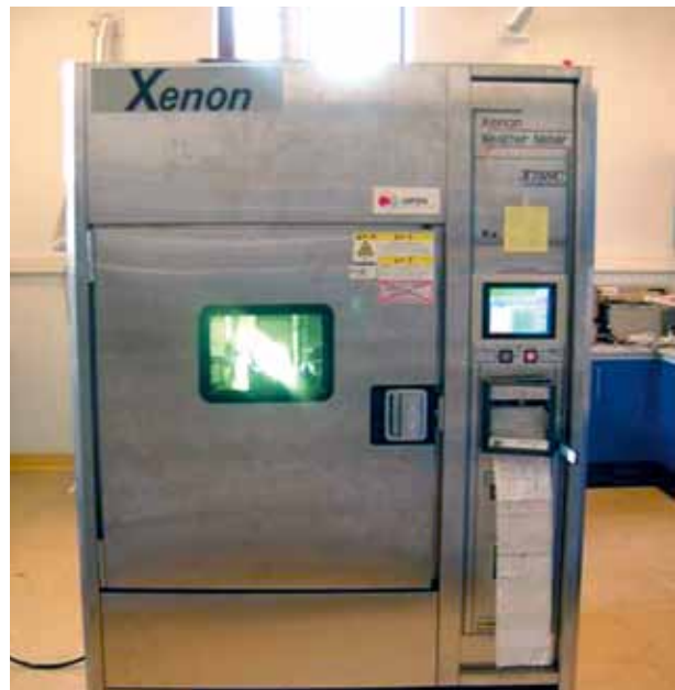
Foto 2: Bloques sometidos a cambios climáticos.
