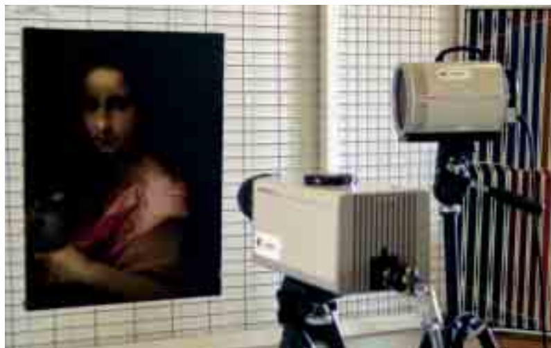
Foto 5. Izquierda, sistema de video cámara para análisis de reflectografía IR. Cámara Hamamatsu modelo C2847. Rango de sensibilidad entre los 700 y los 1800 nm.
