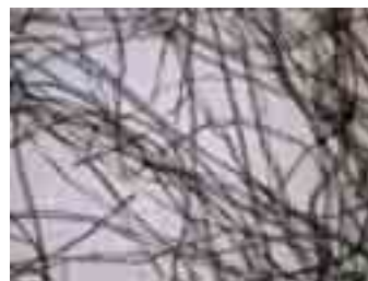
Foto 14. Imagen LPC-029-01-10.jpg de 2272x1704 píxeles. Identificación de fibras. Microscopía óptica con iluminación transmitida de magnificación 10X.
