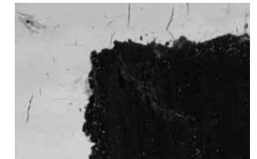
Foto 6: Ensayo de envejecimiento por HR y T. Microfotografía donde se aprecian grietas que han invadido la capa pictórica, en una muestra sin secativo de cobalto. Las grietas son debidas a los cambios dimensionales del soporte y no a la aplicación del secativo.
