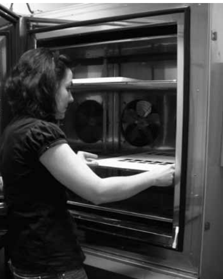
Foto 4: Momento en el que se introduce uno de los modelos experimentales en la cámara de ciclos de envejecimiento por HR y T.
