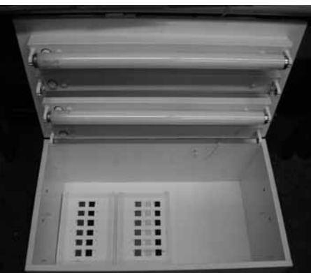
Foto 5: Introducción de los modelos experimentales en la cámara de envejecimiento por UV.
