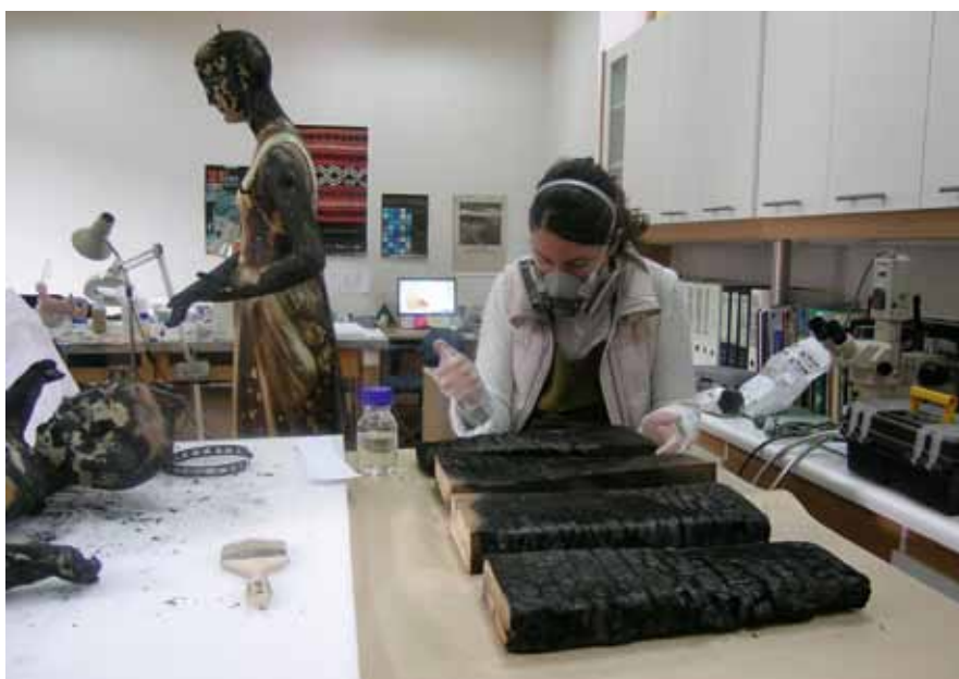
Foto 5. Aplicación de consolidante en prototipos de madera.
