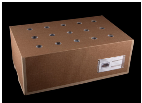
Figura 4. Detalles técnicos de los contenedores elaborados para los individuos NI 6008 y 6009. Imagen izquierda: bandeja con espaciados para inducir ventilación cruzada; imagen derecha: se observan las perforaciones realizadas en la tapa para su ventilación (Fotografías: Roubillard, M. 2013. Archivo CNCR). Technical details of the containers made by the individuals NI 6008 and 6009. Left image: tray with spaces to induce cross ventilation. Right image: perforations can be observed on the lid for ventilation (Photographs: Roubillard, M. 2013. CNCR Archive).
