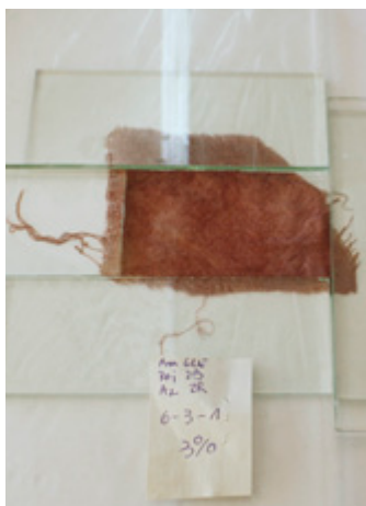
Figura 15. Secado de soporte de etamina de lana teñido con tintes sintéticos, marca Lanaset® (Fotografía: C. Morales, 2012).
