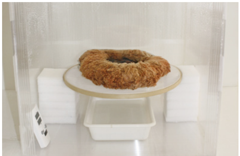
Figura 11. Vista frontal de la cámara de humidificación con la pieza ubicada en su interior, sobre el bastidor (Fotografía: C. Morales, 2012).
