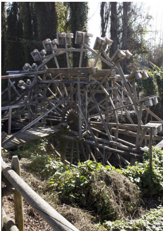
Figura 5. Inferior izquierda. Las ruedas de Larmahue poseen por lo general una forma poligonal debido a la cantidad de rayos que las sostiene (Fotografía: IHP, 2012). Lower Left. The waterwheels of Larmahue generally have a polygonal shape resulting from the number of spokes sustaining them (Photograph: IHP, 2012).
