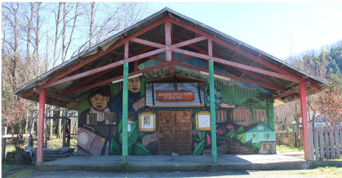
**Figura 8.** Expulpería del complejo industrial, emplazada en el área cívico-administrativa de la localidad. Se caracteriza por un volumen simple, con acceso techado y cubierta a la vista compuesta por cerchas de madera (Fotografía: Archivo CMN, 2016).
