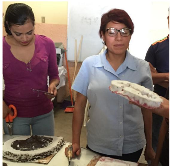
**Figura 2.** Elaboración de moldes de silicón y fibra de vidrio (Fotografía: Hernández, A. 2017).
