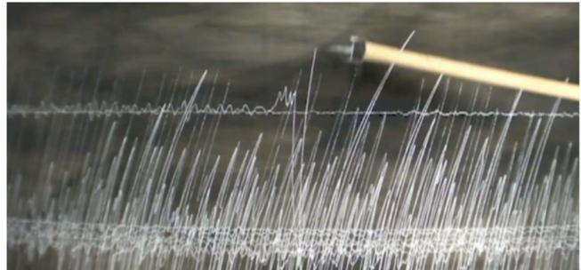
Figuras 8 y 9: Una vez en el sismógrafo, se deben ajustar las agujas y se utilizaba un timbre de goma para colocar la fecha de la medición.
