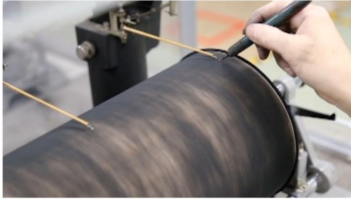
Figuras 7: En esta imagen se puede observar como la aguja del sismógrafo dibuja las líneas sobre el papel, retirando parte de la fina capa de hollín
