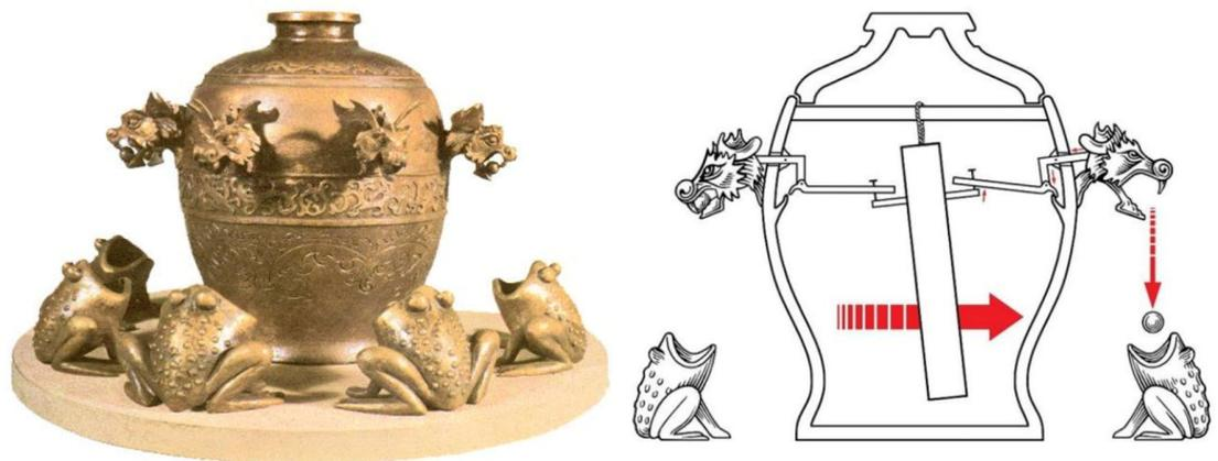
Figura 1: sismoscopio inventado por Hang Chen en 132 D.C. <http://contenidos.inpres.gob.ar/docs/Principio de funcionamiento de los Sismógrafos.pdf>
