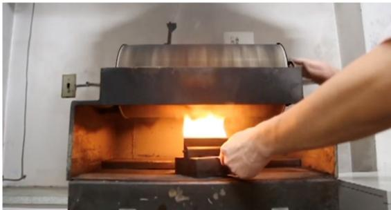
Figura 5: En esta imagen se puede ver el proceso de ahumado con un mechero, mientras se va girando el tambor donde está el papel. Se debe mover el mechero bajo el tambor hasta que se consiga el tono negro deseado
