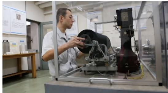
Figura 6: Una vez ahumado el papel, el tambor se debe colocar en el sismógrafo
