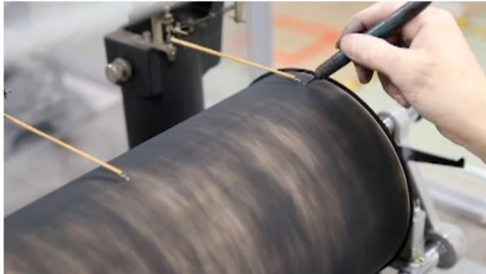
Figuras 9: en esta imagen se puede observar como la aguja del sismógrafo dibuja las líneas sobre el papel, retirando parte de la fina capa de hollín
