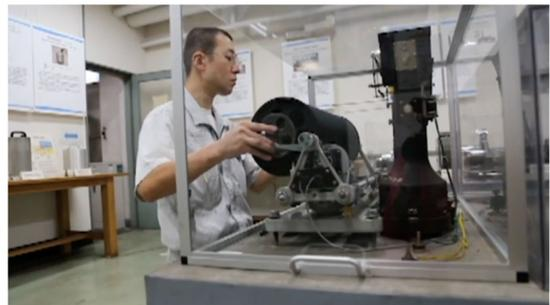
Figura 8: una vez ahumado el papel, el tambor se debe colocar en el sismógrafo
