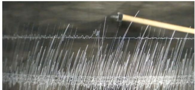
Figuras 10 y 11: una vez en el sismógrafo, se deben ajustar las agujas y se utilizaba un timbre de goma para colocar la fecha de la medición.
