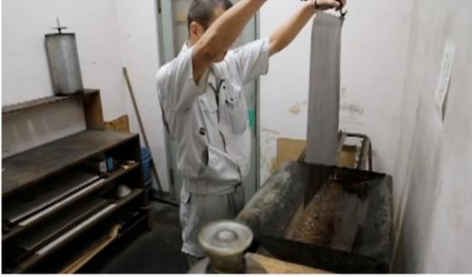
Figuras 12, 13 y 14: una vez terminada la medición, la tira de papel se retira del tambor y se introduce en un baño fijador.
