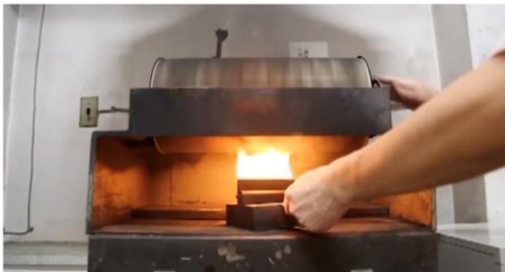
Figura 7: en esta imagen se puede ver el proceso de ahumado con un mechero, mientras se va girando el tambor donde está el papel. Se debe mover el mechero bajo el tambor hasta que se consiga el tono negro deseado
