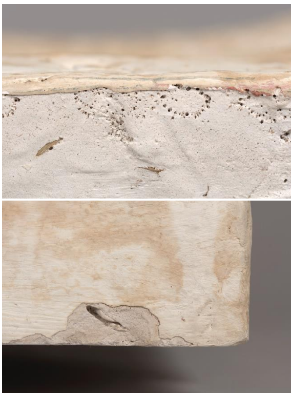
Figura 13. (1) Detalle de diferentes zonas donde existen burbujas como parte del proceso de facturación de la obra (Fotografías: Quiroz, M. 2025. Archivo CNCR. ID. 5272).
