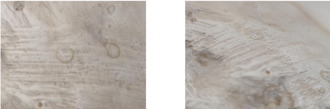
Figura 30. Detalle de pruebas de ángulo de contacto en la superficie de las diferentes zonas cromáticas (Fotografías: Salazar, N. 2025. Archivo CNCR. ID. 5272).
