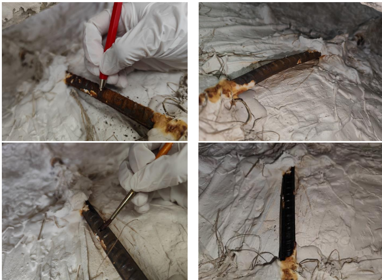
Figura 35. Detalle de eliminación de corrosión, inhibición y protección de elementos metálicos al interior del busto (Fotografías: Salazar, N. 2025. Archivo CNCR. ID. 5272).
