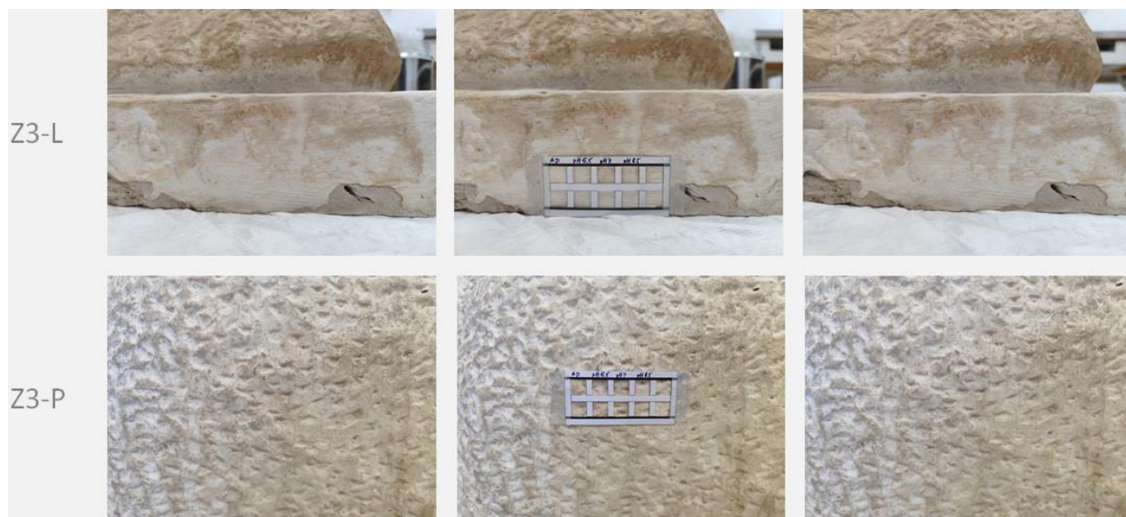
Figura 31. Detalle de pruebas de limpieza acuosa de las diferentes zonas definidas (Fotografías: Salazar, N. 2025. Archivo CNCR. ID. 5272).
