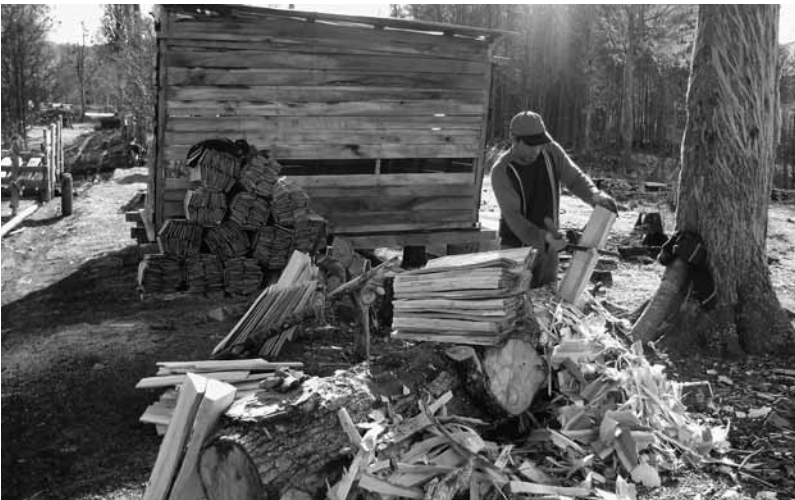
Fotos 1 y 2: Tejueleros en proceso de partida y labrado de la tejuela artesanal.
